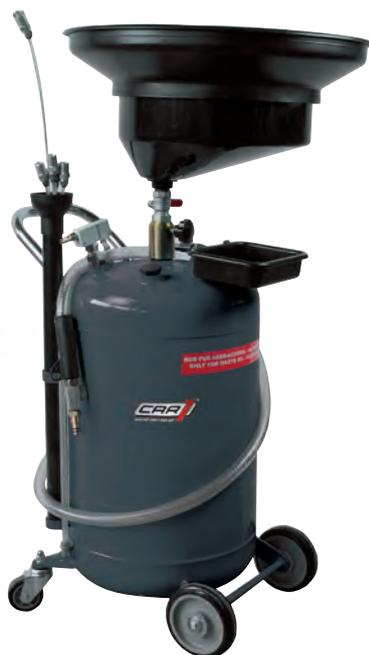
Mobiler Altölabsauger zum Absaugen und Auffangen von Altöl (bekannter Herkunft, Flammpunkt > 55 °C) aus Maschinen und Fahrzeugen. Die Absaugung erfolgt mittels Vakuumprinzip. Behälterinhalt 80 l.
